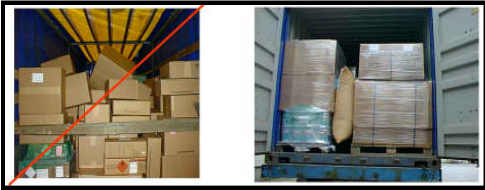
Resim 1.28: Yetersiz (hatalı) ve güvenli yükleme
